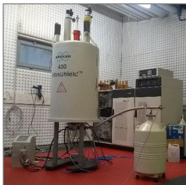
Abbildung 1: v.l.n.r.: Schmelzemuulsion mit unterkühlten und kristallisierten Tropfen; NMR-Messgerät zur Charakterisierung von Emulsionen; beispielhaftes NMR-Spektrum einer n-Hexadecan-in-Wasser Emulsion mit dem Emulgator Tween20.
